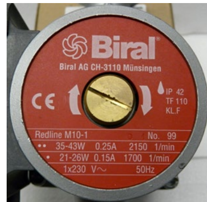
Abbildung 2: Typenschild Pumpe, Quelle: Biral Redline M10-1
